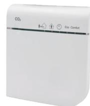
Il sensore wireless di CO<sub>2</sub> rileva il livello di anidride carbonica nell'aria all'interno dell'ambiente in cui è posizionato, inviando le sue misurazioni tramite RF (radiofrequenza) all'unità Zehnder EVO. L'unità varia di conseguenza la sua portata, scegliendo il livello appropriato per garantire la qualità dell'aria interna in base alle informazioni trasmesse del sensore.
