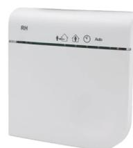
Il sensore wireless rileva l'umidità relativa nell'aria all'interno dell'ambiente in cui è posizionato, inviando le sue misurazioni tramite RF (radiofrequenza) all'unità Zehnder EVO. L'unità varia di conseguenza la portata di ventilazione, scegliendo il livello appropriato per garantire la qualità dell'aria interna in base alle informazioni trasmesse dal sensore.
